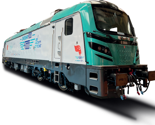
ESKİŞEHİR 5000 Tipi Milli Elektrikli Anahat Lokomotifi
