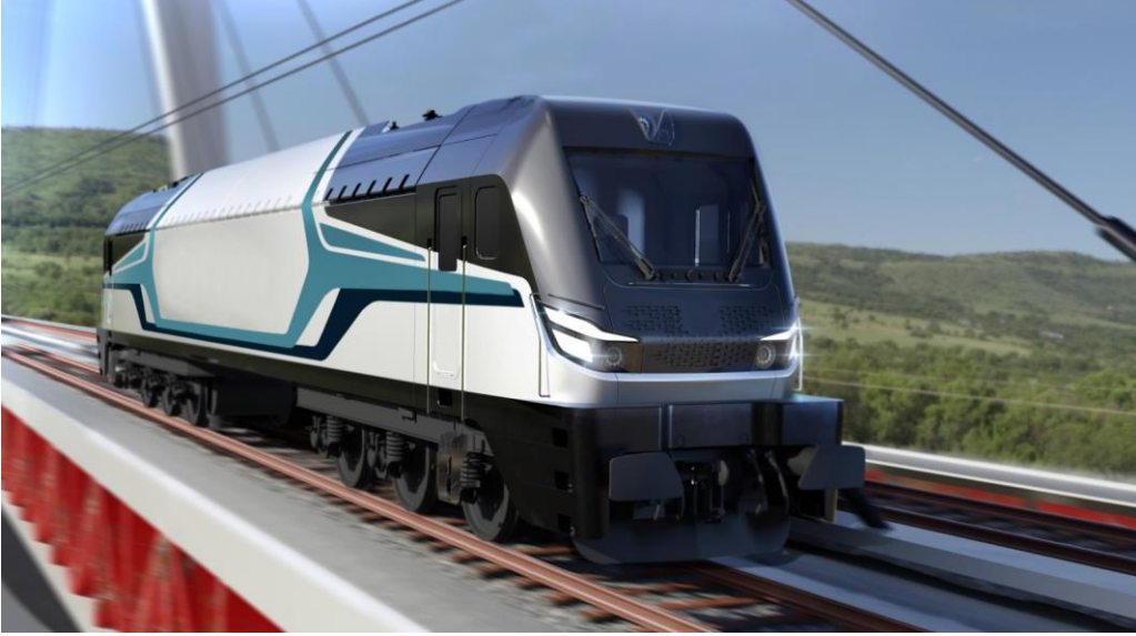
Co-Co Aks Tertibatına Sahip Milli Lokomotif
